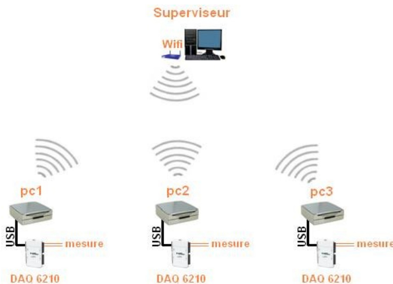
Illustration 37: Synoptique du réseau de capteurs
