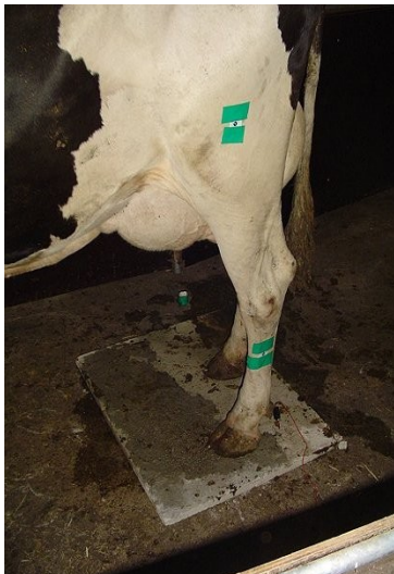
Illustration 41: vache équipée des électrodes de mesure
