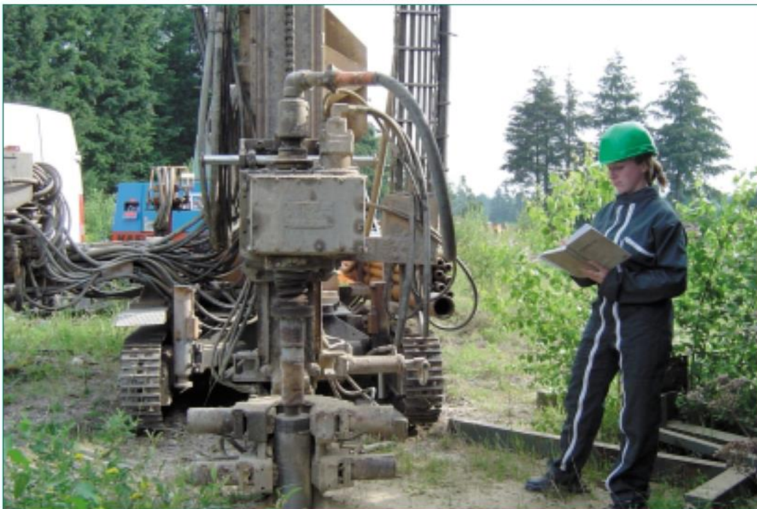
Le diagnostic d'un sol peut nécessiter le prélèvement d'échantillons jusqu'à 30 ou 40 mètres de profondeur.
