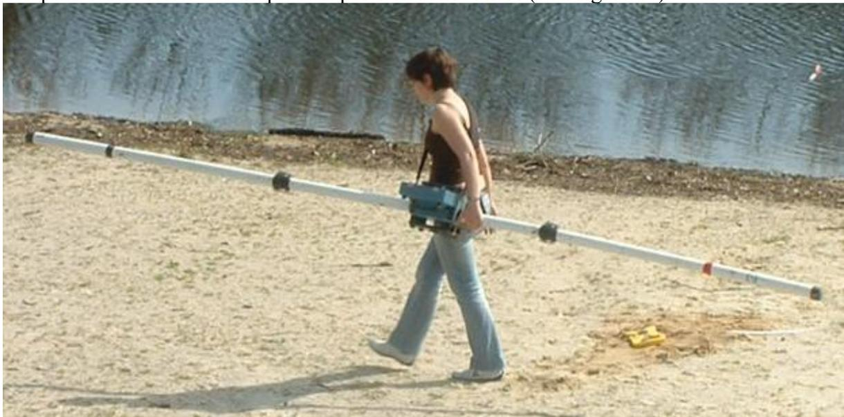
*Figure 13 : Opératrice réalisant des mesures avec l'EM31*
