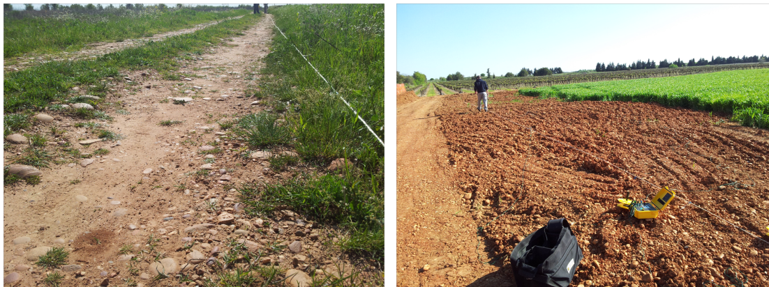
FIGURE 2.4.5 – Deux des trois sites dans la région de Nîmes-Montpellier où des mesures de résistivité apparente de sol par la méthode de Wenner ont été réalisées. La photo de gauche a été prise au deuxième site, alors que celle de droite au troisième.
