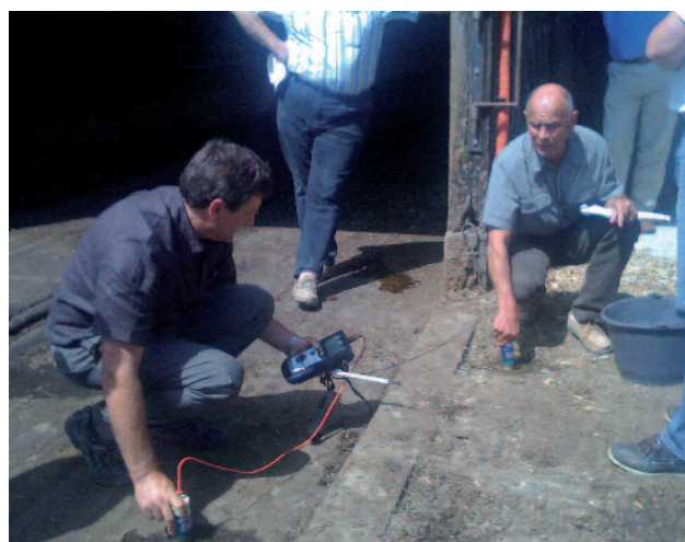
Figure 2 : Mesure ponctuelle de la tension de pas sur un couloir (Cliché A. Laval).
